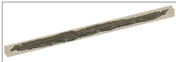
Σχ. 11. Τρισδιάστατη απεικόνιση βάθους εμποτισμού ξυλείας οξιάς με κραμβέλαιο
